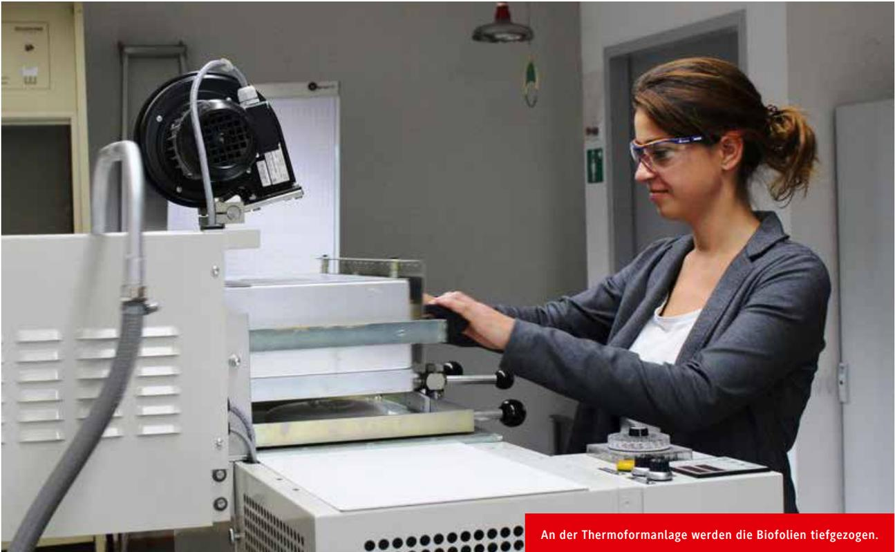
An der Thermoformanlage werden die Biofolien tiefgezogen.
