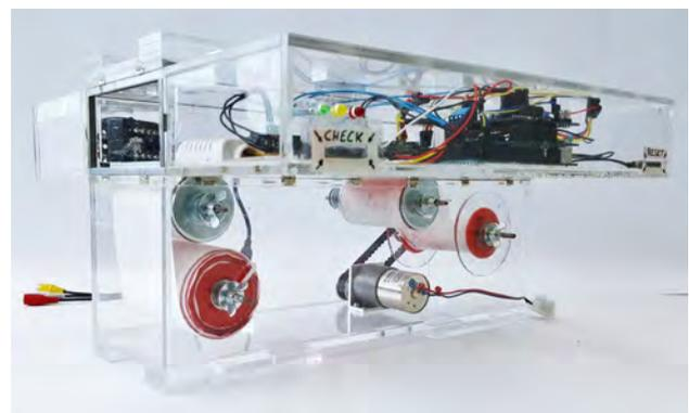
Bewegungssensoren triggern das mit einem Komposit bespannte Rollensystem, sodass Kot- und Urinproben aufgenommen und mittels RFID den einzelnen Siebenschläfern zugeordnet werden können
